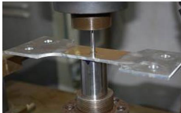
Рисунок. 4.9. Фото пластини під час дорнування
